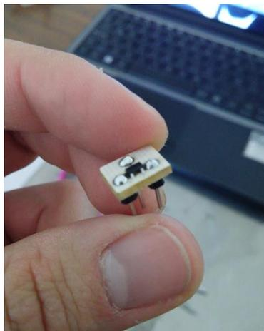
**Figura 3.14 MOSFET BSS138 montado en circuito impreso.**
