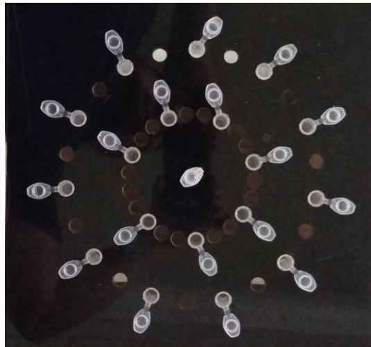
Figura 17. Irradiación de los TLDs para calibración
