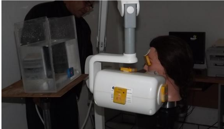
Figura 23. Embalaje de los TLDs en el fantoma de agua
