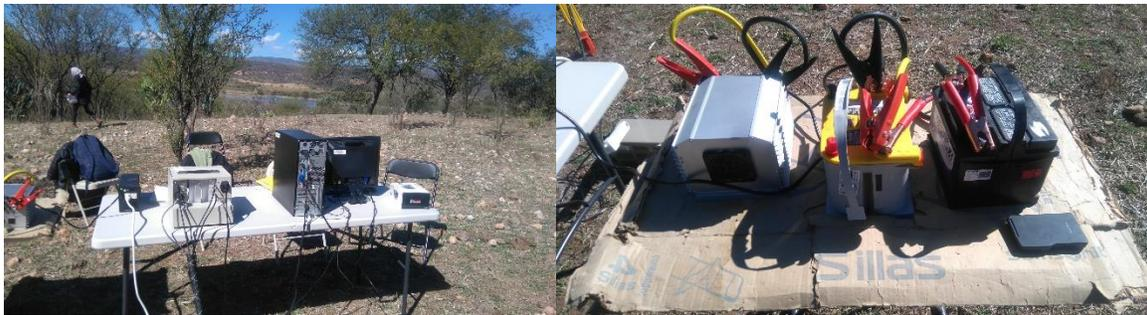
Figura. 6 NIM/BIN (Fuente de voltaje y amplificador), alimentado mediante las baterías (de gel y líquida) conectado al inversor de voltaje, dando una salida 117 Volts AC.
