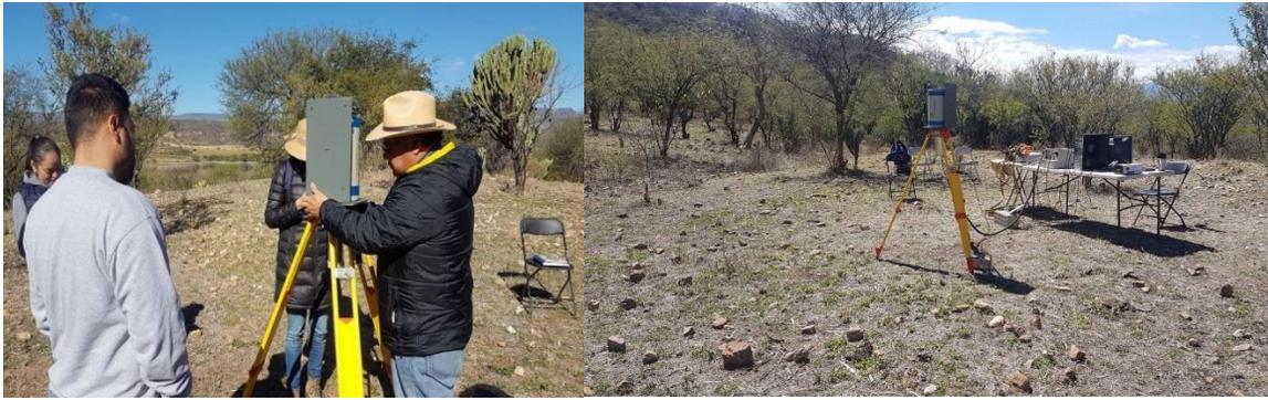
Figura. 5 Detector a 1 m de altura del suelo con cristal de Germanio con dirección hacia abajo, sin blindaje.
