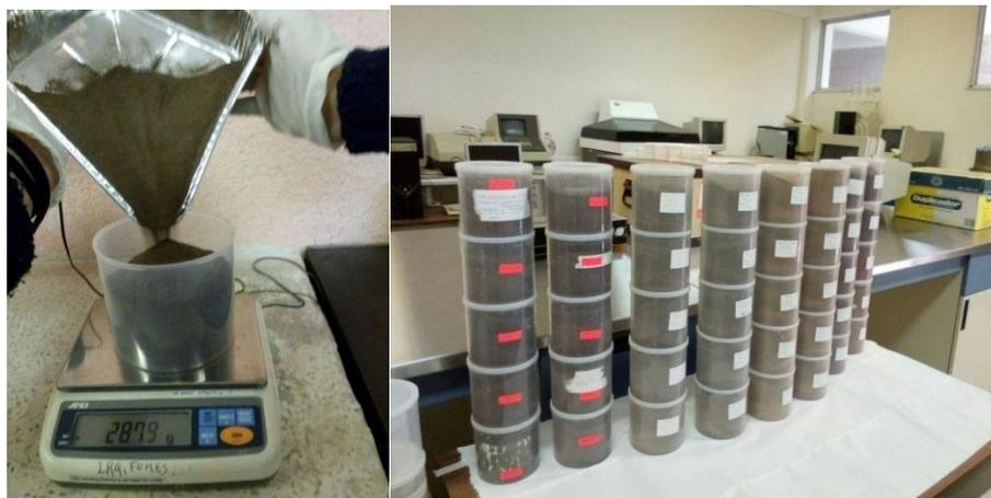
Figura. 9 Vaciado y sellado de muestras en Marinellis.
